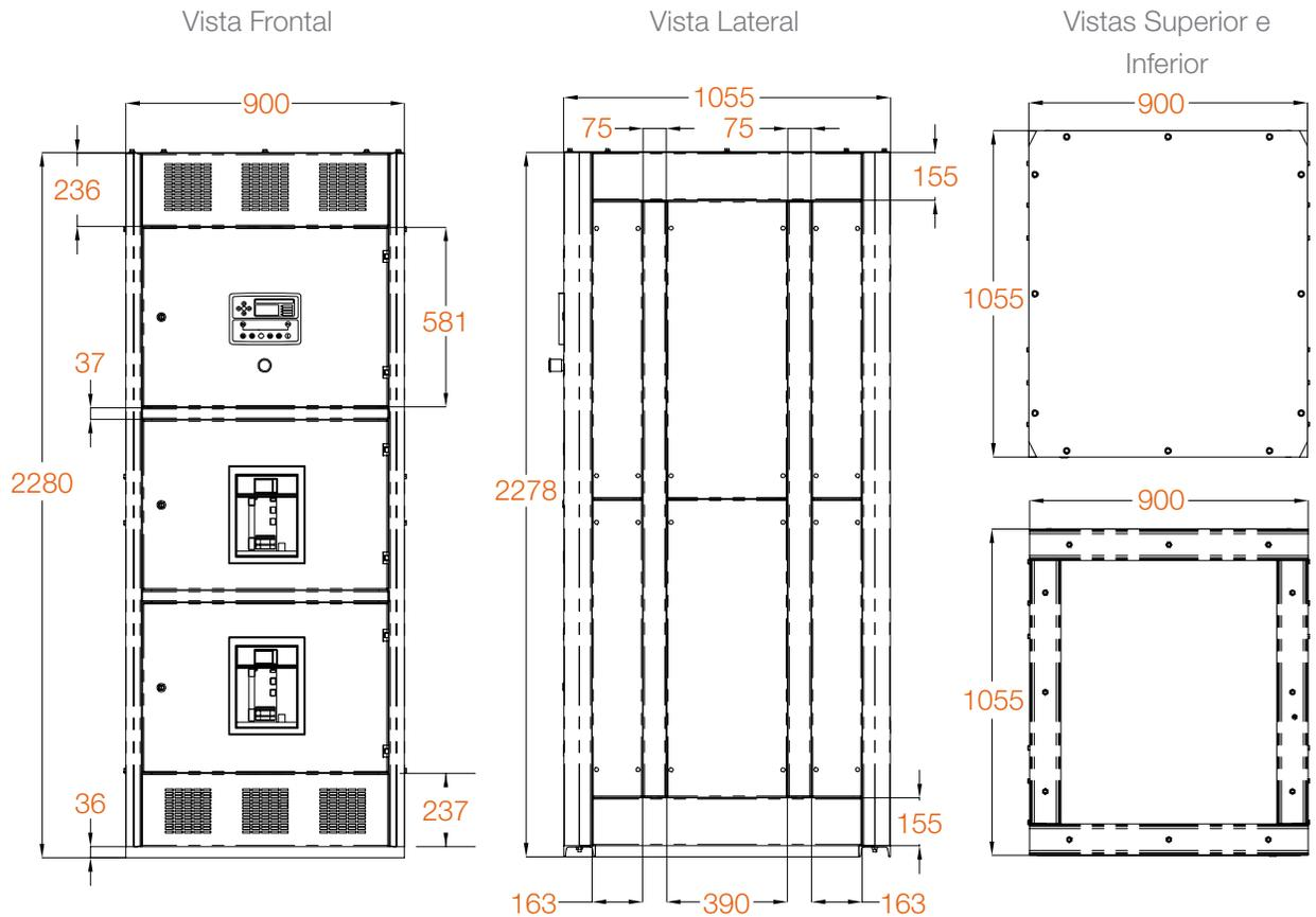
\*Acceso para cables de fuerza en la parte inferior y/o superior. Dimensiones en milímetros.
